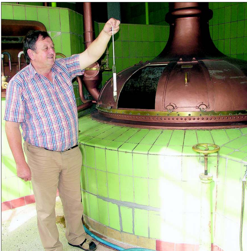
Mit der Spindel misst Braumeister Jupp Brantl die Stammwürze seines Bieres.
